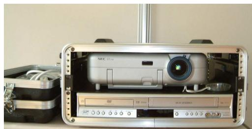
Die Geräte sind komplett miteinander verkabelt und es wird nur eine Netzstecker eingesteckt.
